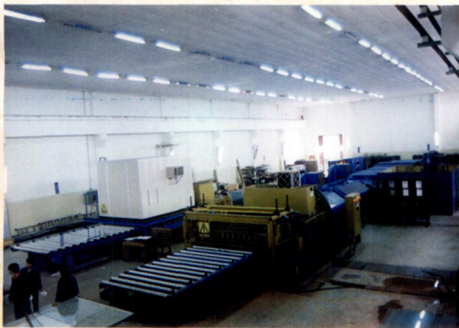
四川玻璃股份有限公司真空平面磁控溅射镀膜玻璃生产线
