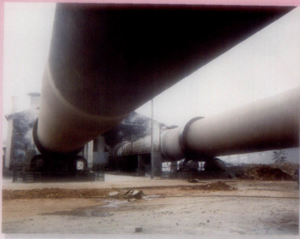
峨眉水泥厂年产百万吨水泥大窑
